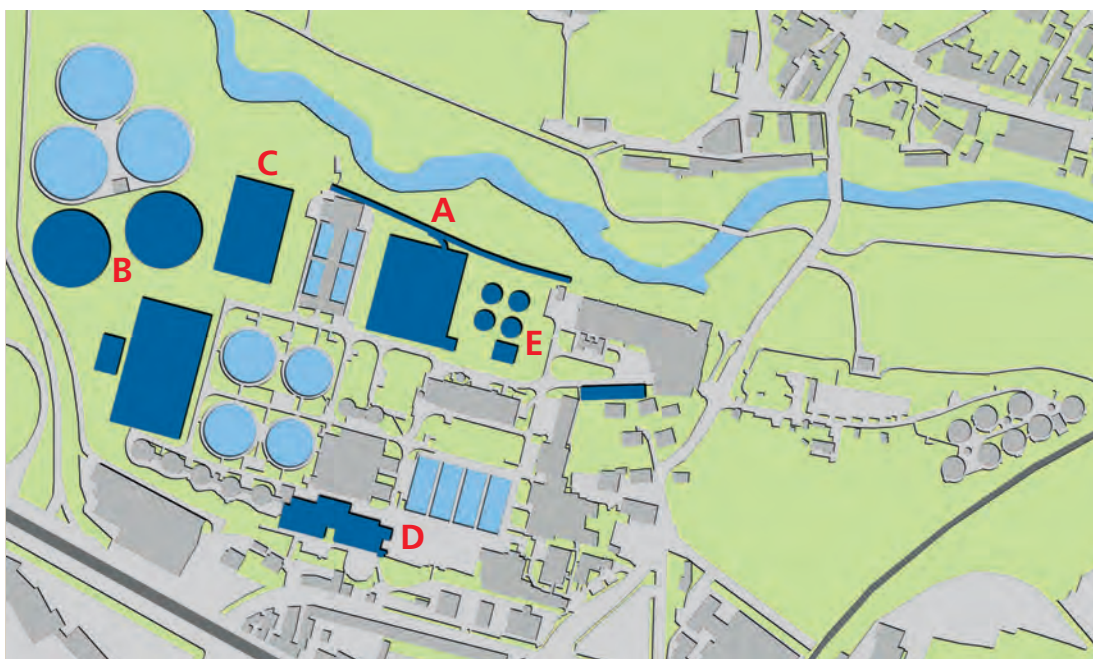
Nach Abschluss der Erneuerung: Die neuen Anlagen im Klärwerk 1: A: Vorklärung B: Zweite biologische Stufe C: Spurenstoff-Elimination D: Schlammbehandlung E: Gasanlagen (schematische Darstellung der möglichen Umsetzung). Grafik: SUN.
