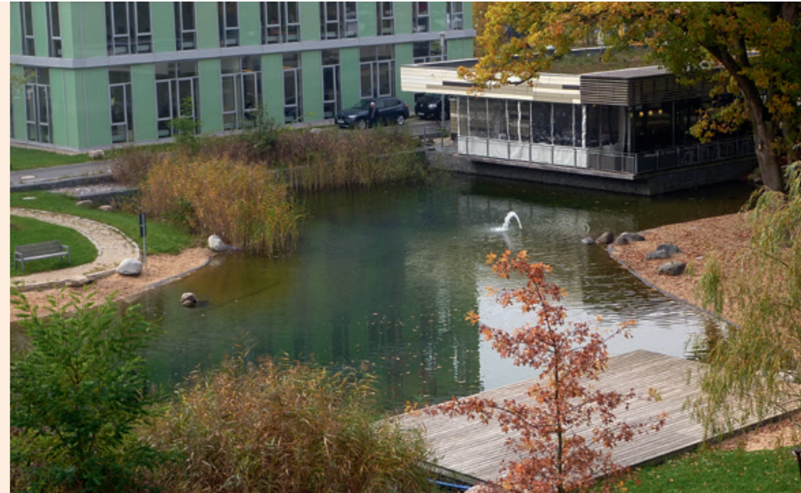
Abb. 4.14: Der Campus-See im Nordostpark nutzt das von den benachbarten Versiegelungsflächen abfließende Regenwasser.
