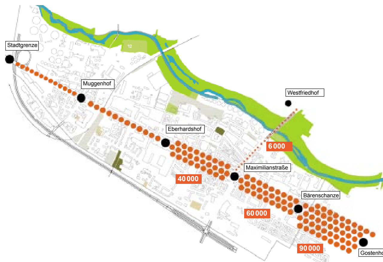
■ 12 Tägliche Belastung des ÖPNV-Netzes im Bereich Nürnberger Weststadt und Umgebung (eigene Darstellung nach [Verkehrsplanungsamt 2003], [Verkehr Nürnberg 2012])
